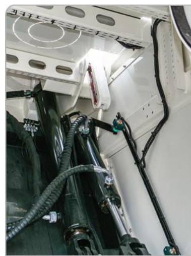
Wewnętrzne siłowniki płyty nośnej
