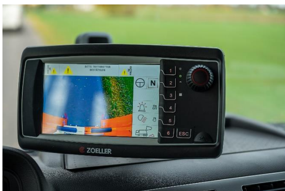
ZOELLER CONTROL SYSTEM - terminal sterujący w kabinie
