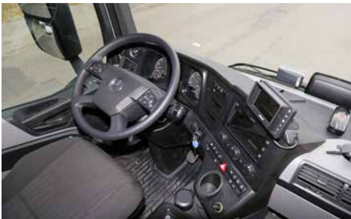
Niski profil tablicy rozdzielczej ułatwia obserwację obszaru przed pojazdem. Po prawej stronie został zamontowany dodatkowy monitor, który wyświetla obraz rejestrowany przez kamerę umieszczoną w górnej części odwłoka.
